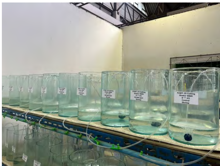
รูปที่ 10 การทดลองขั้นต้น (Range Finding Test) ของ FUWT-25 Cutting Shaker WBM 8 \frac{1}{2} "
