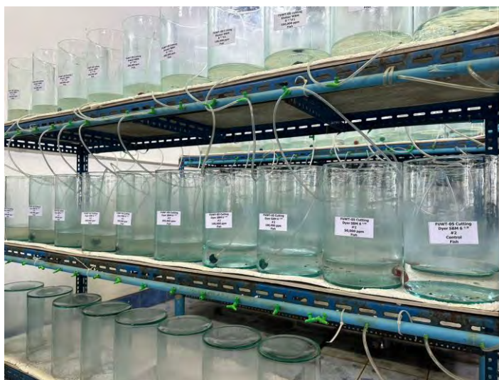
รูปที่ 7 การทดลองขั้นต้น (Range Finding Test) ของ FUWT-05 Cutting Dryer SBM 6 1 / 8 "
