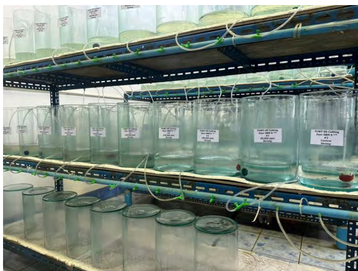
รูปที่ 7 การทดลองขั้นต้น (Range Finding Test) ของ FUWT-05 Cutting Dryer SBM 6 \frac{1}{8} "
