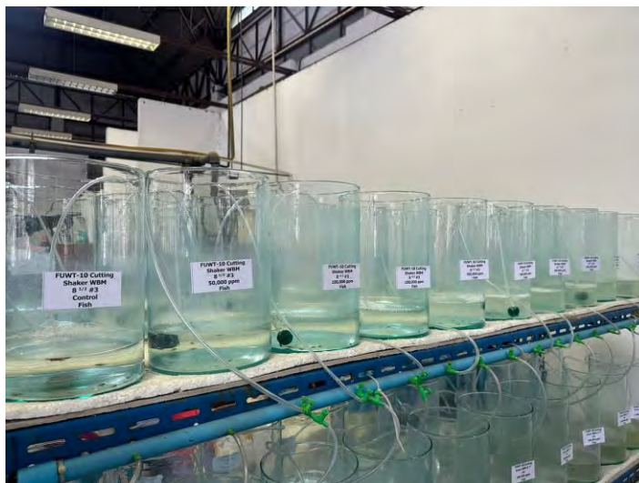
รูปที่ 8 การทดลองขั้นต้น (Range Finding Test) ของ FUWT-10 Cutting Shaker WBM 8 1 / 2 "
