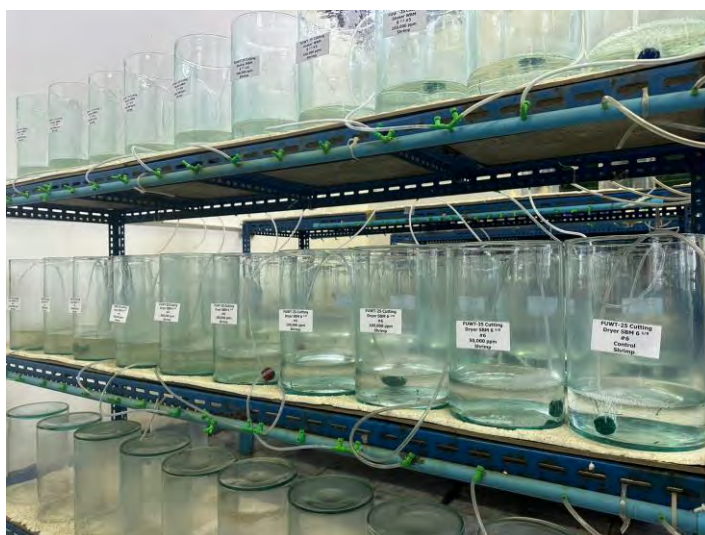
รูปที่ 11 การทดลองขั้นต้น (Range Finding Test) ของ FUWT-25 Cutting Dryer SBM 6 \frac{1}{8} "
