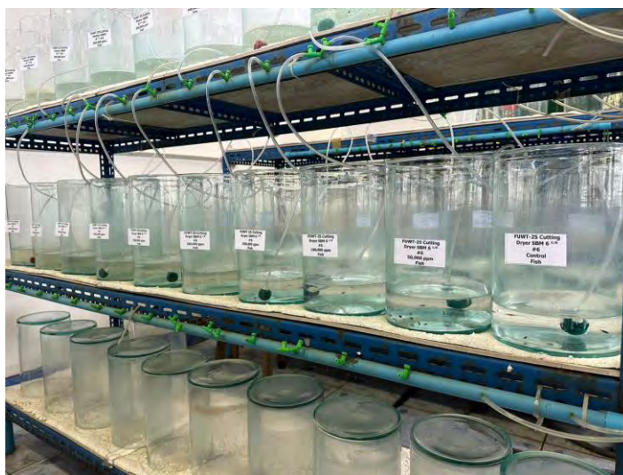
รูปที่ 11 การทดลองขั้นต้น (Range Finding Test) ของ FUWT-25 Cutting Dryer SBM 6 \frac{1}{8} "
