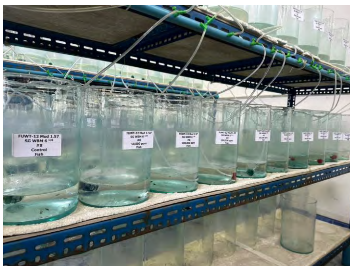
รูปที่ 13 การทดลองขั้นต้น (Range Finding Test) ของ FUWT-12 Mud 1.57 SG WBM 6 1 / 8 "
